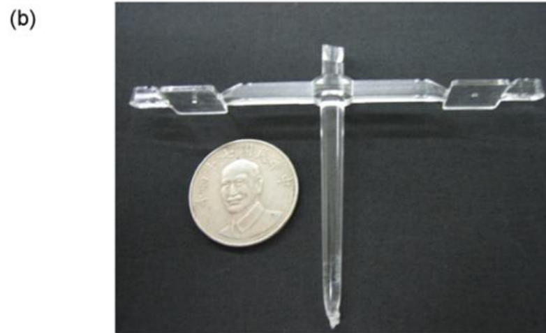
Hình 1.4: Thiết kế khuôn cho sản phẩm phun ép nhựa dạng micro, (a) khuôn phun ép, (b) sản phẩm dạng micro [98]
