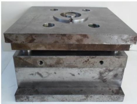
Hình 3.14: Bộ khuôn chế tạo mẫu thử kéo ASTM D368
