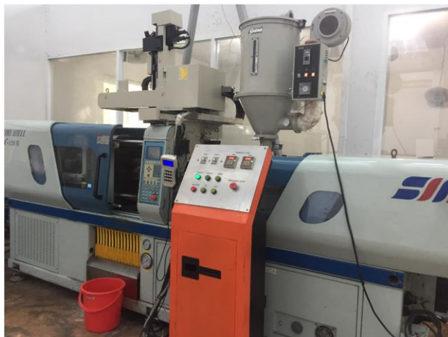
Hình 3.12: Máy phun ép nhựa SW-120B có tích hợp tay máy gia nhiệt
