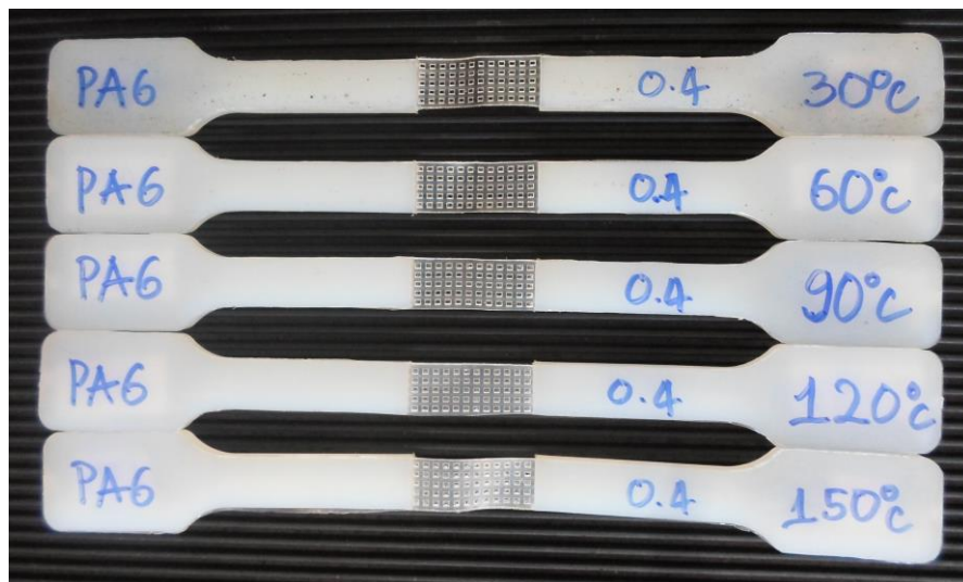
Hình 5.20: Sản phẩm có chiều dày lưới 0,4 mm ứng với các mức nhiệt độ lòng khuôn 30 °C, 60 °C, 90 °C, 120 °C và 150 °C
